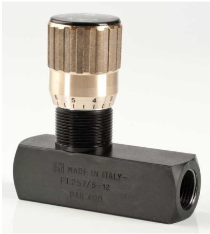
Tognella FT257/5-100, Válvula reguladora unidireccional en línea, con roscas hembra 1" BSP en los dos lados. (320BAR)
