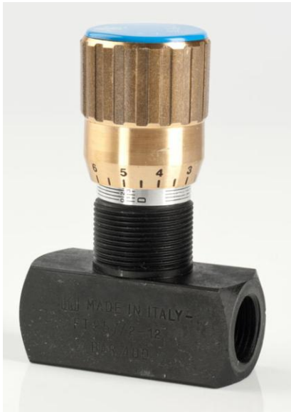
Tognella FT257/2-114, Válvula reguladora bidireccional en línea, con roscas hembra 1"1/4 BSP en los dos lados. (320BAR)
