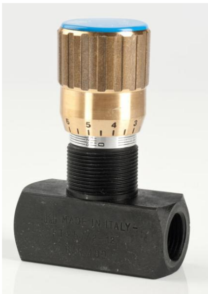
Tognella FT257/2-112, Válvula reguladora bidireccional en línea, con roscas hembra 1"1/2 BSP en los dos lados. (320BAR)
